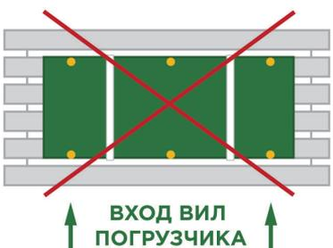
Габаритные размеры теплообменника значительно меньше поддона. Подъем с помощью строп может привести к поломке поддона. Возможно использование погрузчика.
